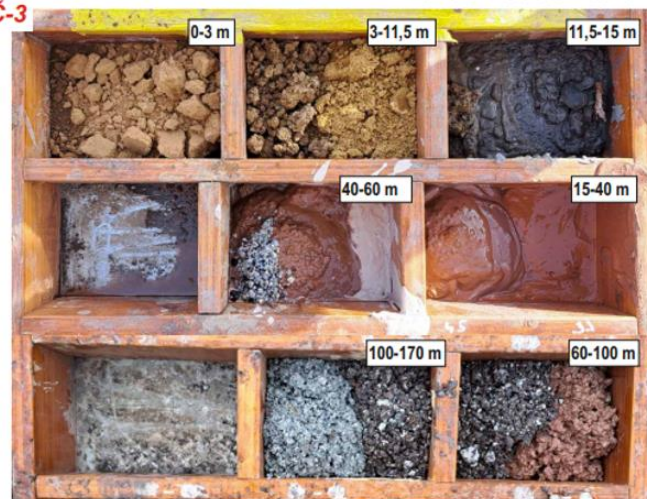
Vzorkování vrtné drtě z vrtu TČ-3.
